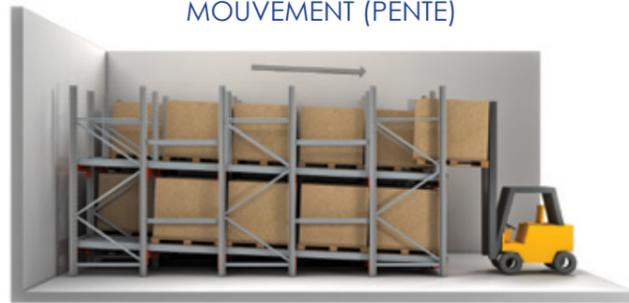
Le dynamique est un système de stockage gravitaire permettant de stocker des palettes à l'intérieur de couloirs composés d'échelles et de nappes de rouleaux.
