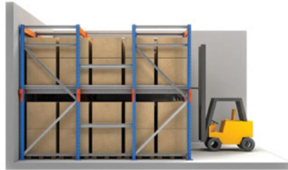
Installation composée de couloirs de stockage dans lesquels les chariots entrent et sortent pour déposer et/ou récupérer les palettes. Les palettes reposent sur des rails fixés sur toute la profondeur des couloirs à l'aide de connecteurs spécifiques.
